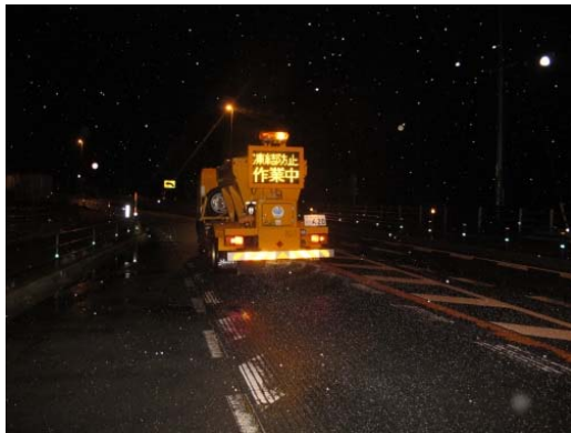
凍結防止剤散布車 ※凍結防止剤を散布する 機械
