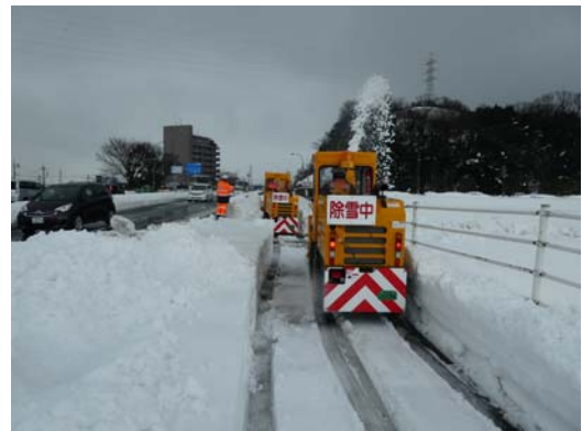
小型ロータリ除雪車 ※歩道に溜まった雪を 取り除く機械
