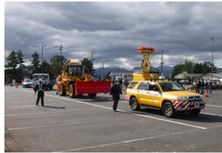
除雪機械による車両移動
