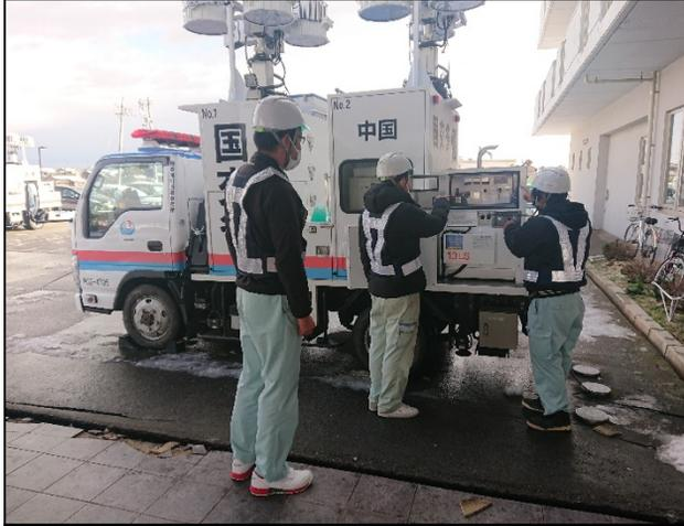
照明車に搭載の発電機を運転し電源を供給
