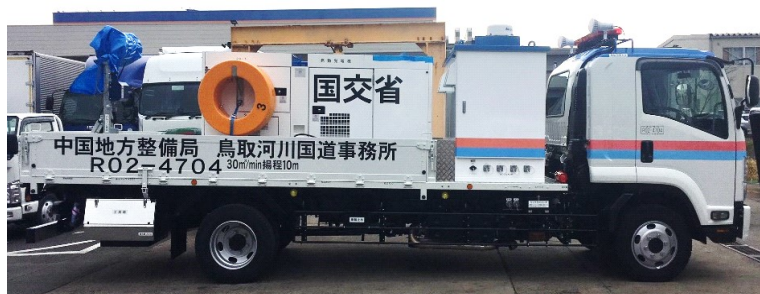
【排水ポンプ車 水中ポンプ4台搭載】
