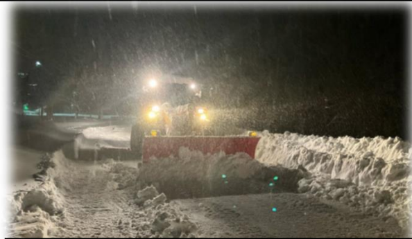
除雪ドーザによる道路除雪 (国道29号)
