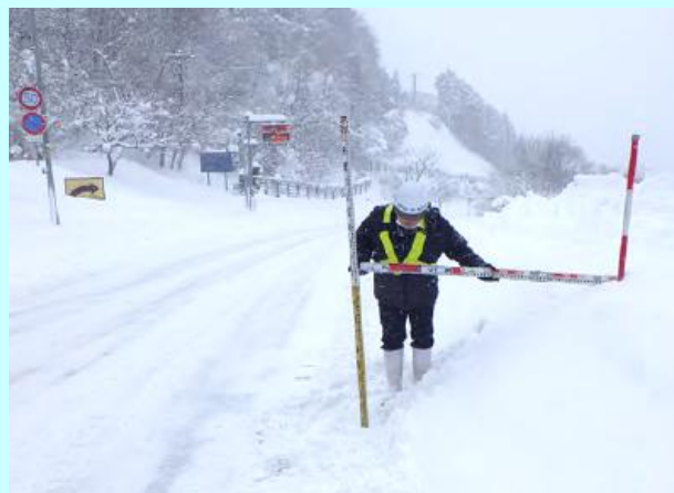
道路巡回(積雪状況確認)【八頭郡智頭町】
