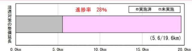
図 2.1.2 堤防の浸透対策進捗状況図 (令和 3 年 3 月末時点)
