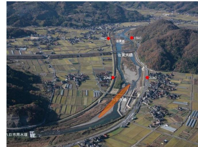
図 5.1.17 千代川 高水敷掘削・中州掘削の位置図(20.1k～20.5k)
