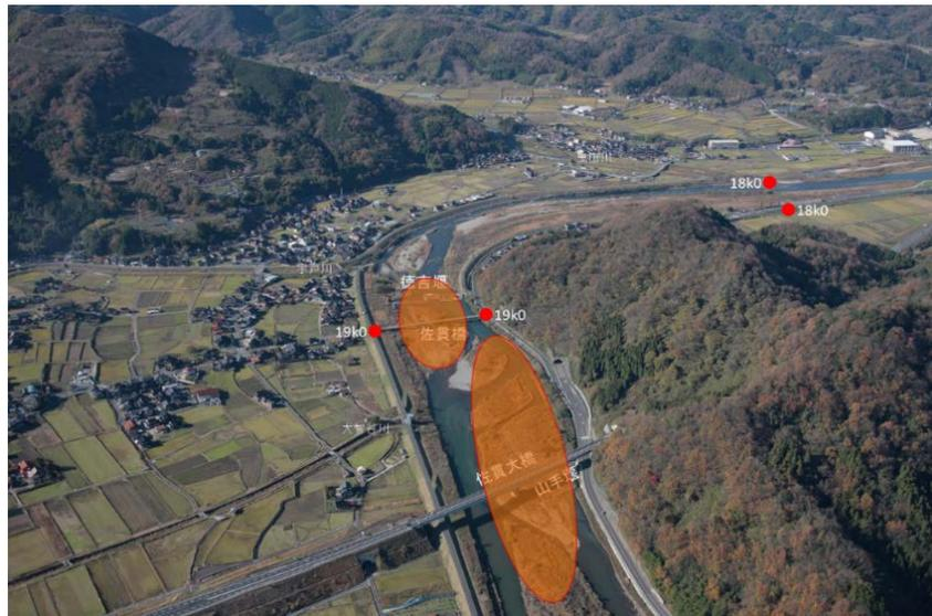
図 5.1.15 千代川 高水敷掘削・中州掘削・徳吉堰改築・山手堰改築の位置図(18.9k~19.7k)
