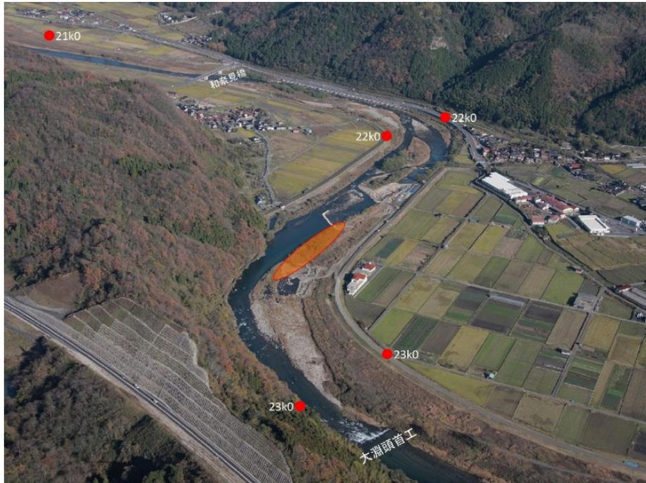
図 5. 1. 23 千代川 高水敷掘削の位置図 (22. 5k~22. 7k)
