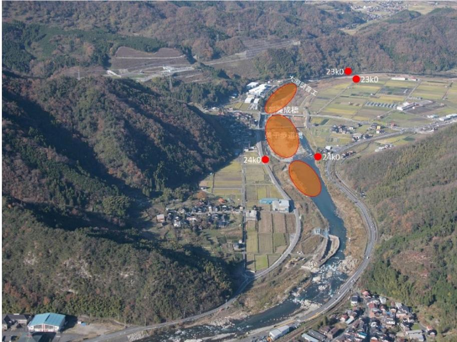
図 5. 1. 25 千代川 低水路掘削・高水敷掘削の位置図 (23. 3k～24. 3k)
