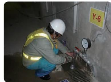
ダム堤体底の管理用トンネルで浸透量を観測する様子
