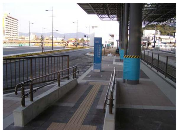
ターミナル入口から路面電車乗り場(左上)、乗合バス乗り場(右上)、タクシー乗り場(左下)まで連続した”ひさし”により連絡され、その経路上はすべてフラットとなっている。また身障者専用の乗降場(右下)も他の交通機関の乗り場と同様に設置され、ターミナルと連絡されている。その身障者専用の乗り場は乗降しやすさを考慮され、スロープにより周りの高さより低く設定されている。
