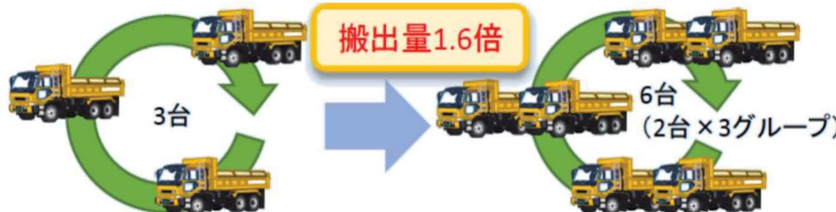
施工能力が増えたが、ヤードの離合箇所の制約があり、ダンプ3台が限界
