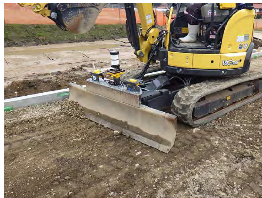
排土板制御システム流用(幅1.55m)
