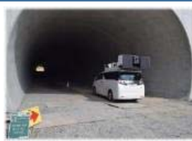
写真7. MMSによる計測状況
