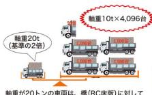
軸重が20トンの車両は、橋(RC床版)に対して 軸重10トンの車両約4,000台分の疲労を 蓄積させることになります。
