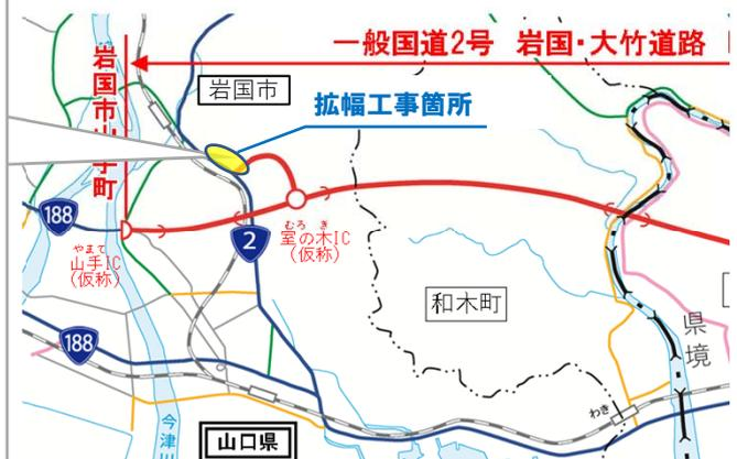
今後は、拡幅した箇所周辺に電線共同溝(道路の地下に電力線、通信線等をまとめて収容する施設)を設置し、その後、車道や歩道の整備を行う予定です。
