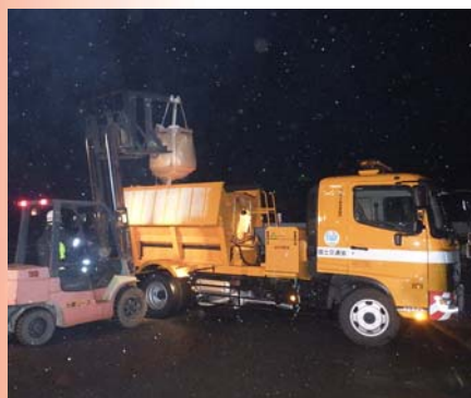
新しく配備された簡易着脱式スノープラウ付凍結防止剤散布車
