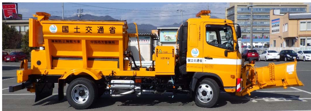
新しく配備された簡易着脱式スノープラウ付凍結防止剤散布車
