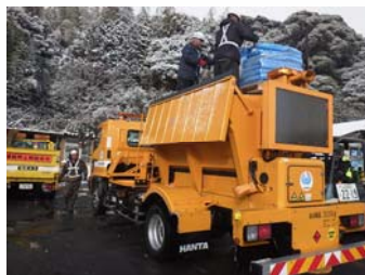
新しく配備された簡易着脱式スノープラウ付凍結防止剤散布車
