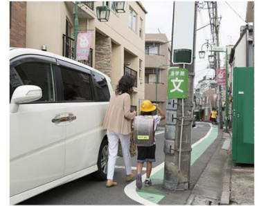
<歩行の支障となる電柱の事例>
