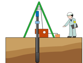
ボーリング調査
