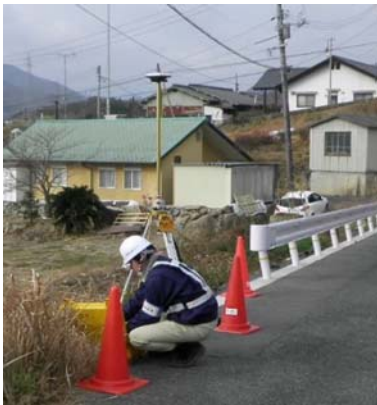
GPS観測機械による基準点測量(例)
