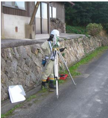
測量機器による地形測量(例)
