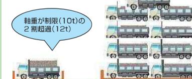
仮に、大型車両1台が、軸重10トンの基準よりも2トン超過した場合は、舗装に対しては約2台分、RC床版に対しては約9台分の疲労が蓄積されることとなります。
