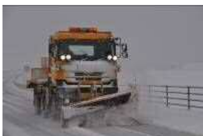
除雪トラック ※雪を取り除く機械
