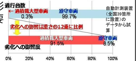
⇒ 軸重20トン車が道路橋に与える影響は、軸重10トン車の約4,000台に相当
