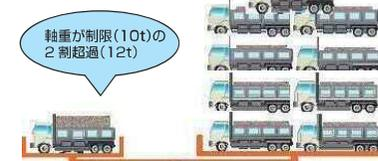
仮に、大型車両1台が、軸重10トンの基準よりも2トン超過した場合は、舗装に対しては約2台分、RC床版に対しては約9台分の疲労が蓄積されることとなります。
