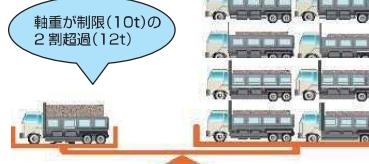
仮に、大型車両1台が、軸重10トンの基準よりも2トン超過した場合は、舗装に対しては約2台分、RC床版に対しては約9台分の疲労が蓄積されることになります。
