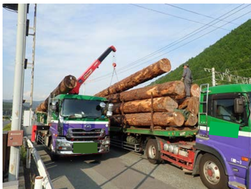
減載措置 (積替え作業)
