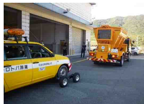
【除雪機械による車両の牽引】
