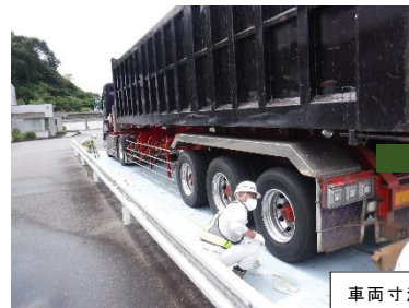
車両寸法計測状況
