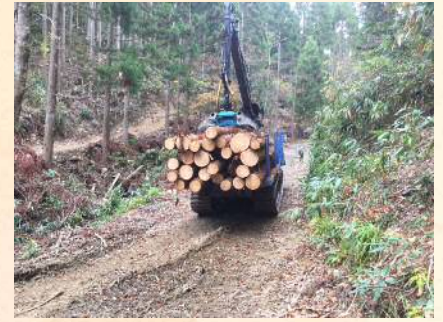
グラップルクレーン付フォワーダによる伐採木の収集運搬 「高性能林業機械」の導入により効率的な集積作業を行っている
