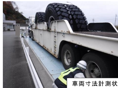
車両寸法計測状況
