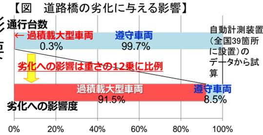
➡ 軸重20トン車が道路橋に与える影響は、軸重10トン車の約4,000台に相当
