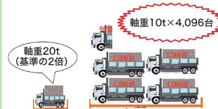
軸重が20トンの車両は、橋(RC床版)に対して軸重10トンの車両約4,000台分の疲労を蓄積させることとなります。
