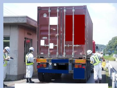
車両寸法計測（幅）
