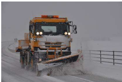
除雪トラック ※雪を取り除く機械
