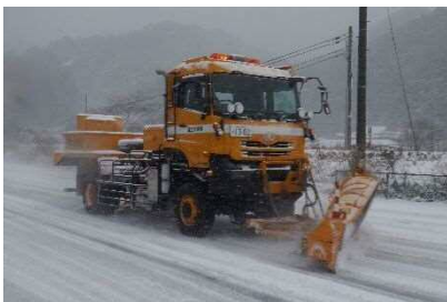
除雪トラック ※雪を取り除く機械
