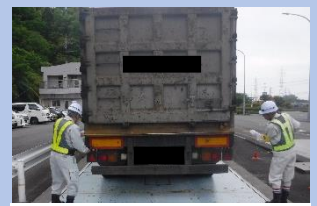
車両寸法計測（幅）
