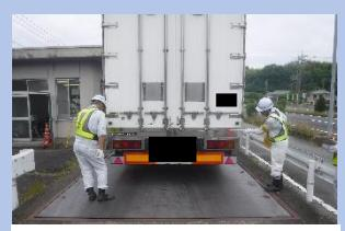
車両寸法計測（幅）
