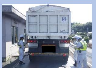
車両寸法計測（幅）
