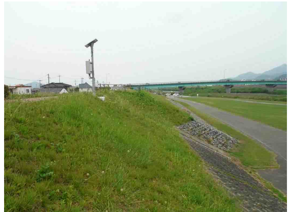
危機管理型水位計の設置イメージ (佐波川)
