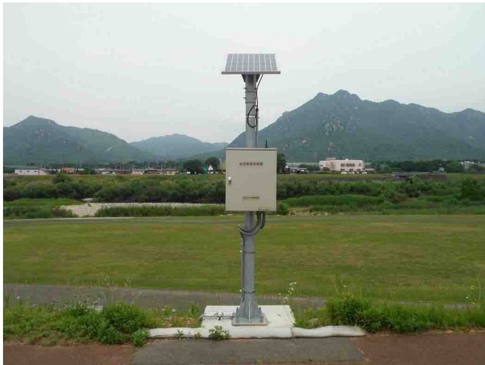
危機管理型水位計の設置イメージ (佐波川)
