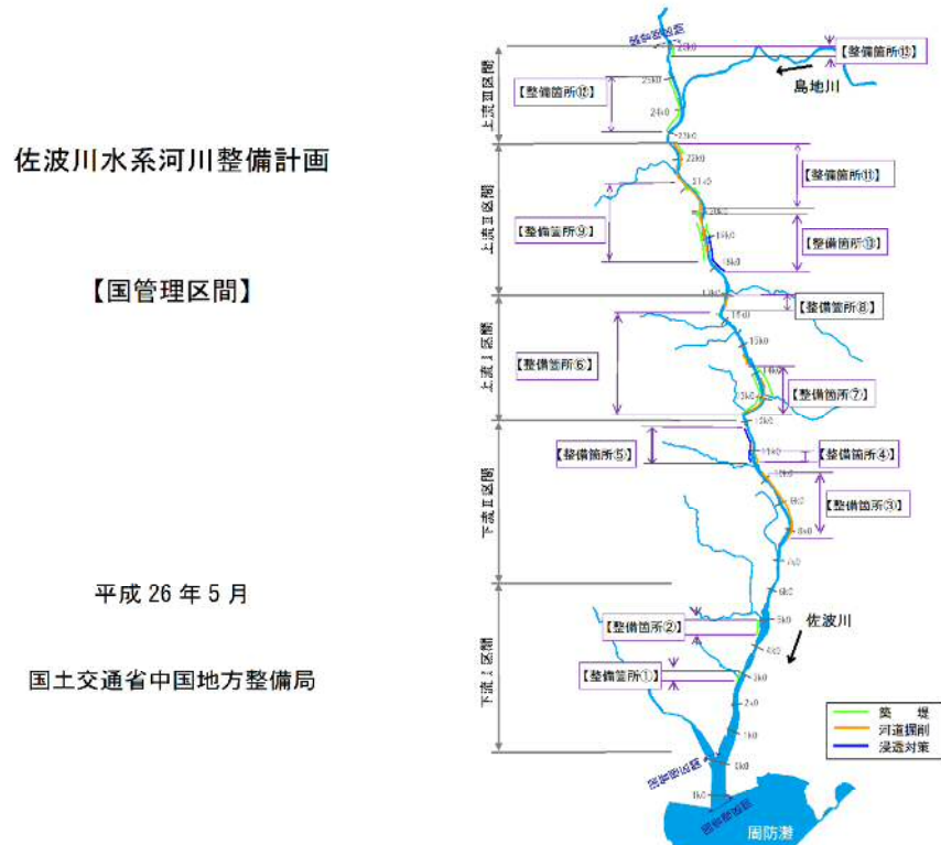
図5.1.2 堤防・河道の整備を実施する箇所
