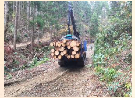
グラップル付フォワーダによる伐採木の収集運搬 「高性能林業機械」の導入により効率的な集積作業を行っている
