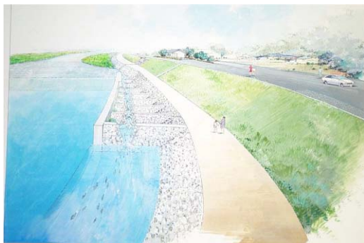
(右岸)粗石斜路式魚道
