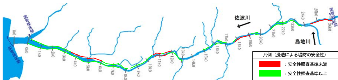
図3.1.3 堤防詳細点検の実施状況
