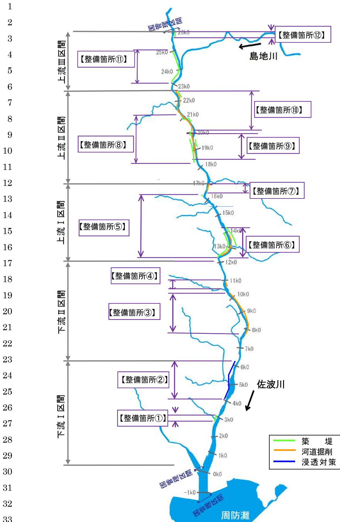
図5.1.2 堤防・河道の整備を実施する箇所
