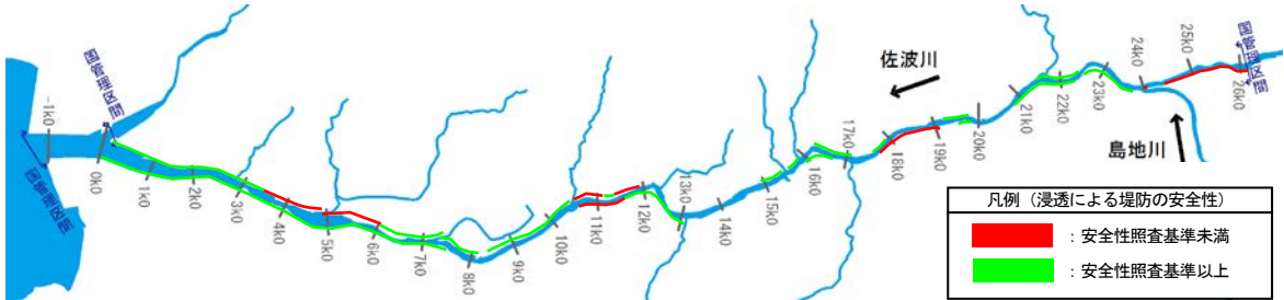
図3.1.3 堤防詳細点検の実施状況
