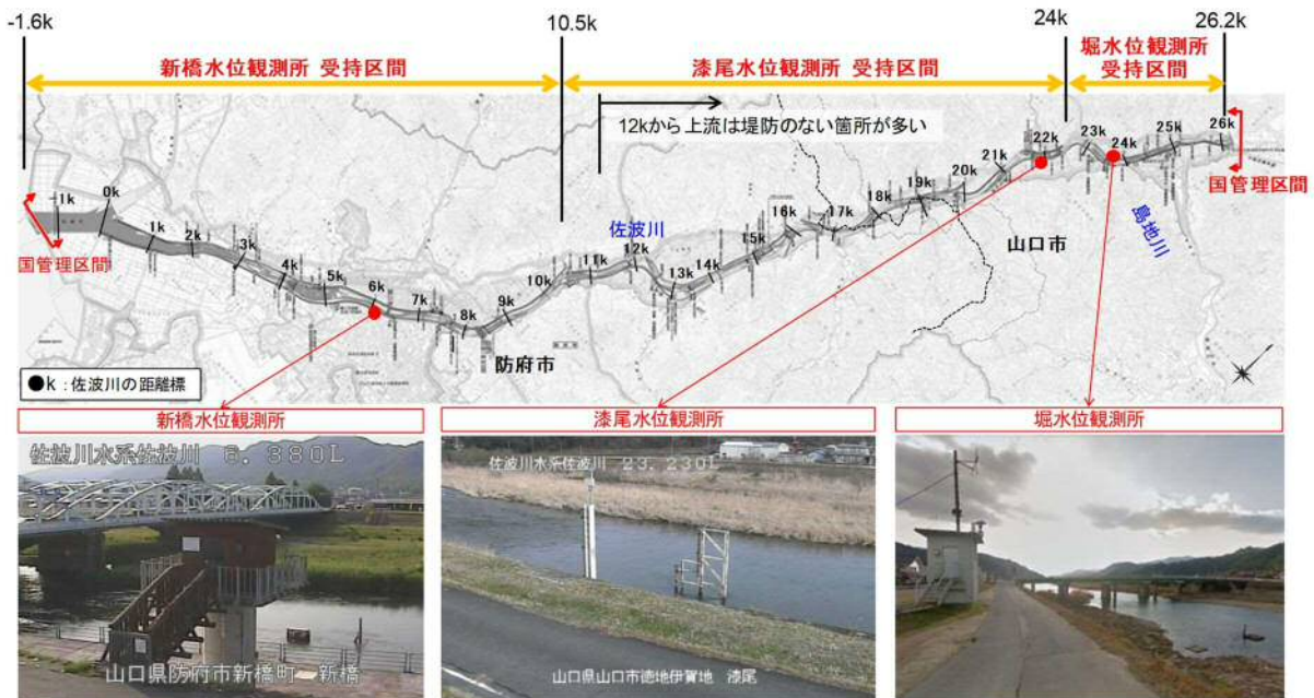
図 2-3 佐波川国管理区間における水位観測所位置と受持区間
