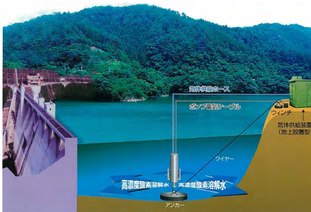
図 3-1 高濃度酸素溶解装置（湖底アンカー式）概念図
