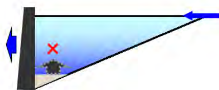
図 3-3 H24以降の運用方針:D0供給を継続し、底層部に沈降した重金属の再溶出を防ぐ
