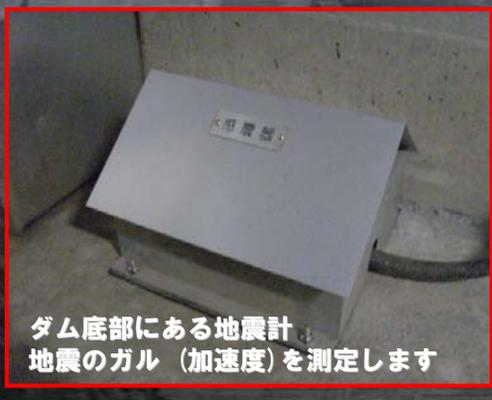
ダム底部にある地震計。地震のガル（加速度）を測定します
