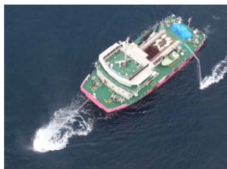
写真18 海洋清掃船による油拡散作業
