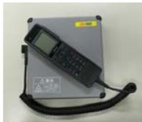
・通信衛星を経由して、固定電話、携帯電話、衛星携帯電話との通話ができる。
