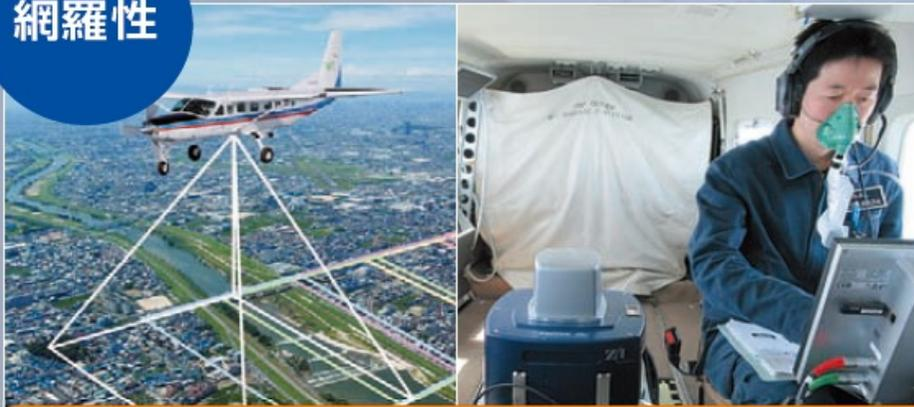
測量用航空機（くにかぜⅢ）による空中写真撮影のイメージ(左)と搭載中の航空カメラ(右)
