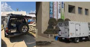
倉敷市真備支所で稼働する小型電源車(左)と中型電源車(右)
