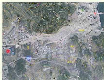
正射画像に電子国土基本図 (地図情報) の主な項目を重ねた「正射写真地図」
