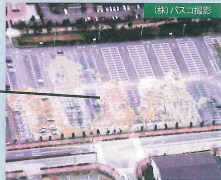
福岡県西方沖を震源とする地震による百道浜の液状化
