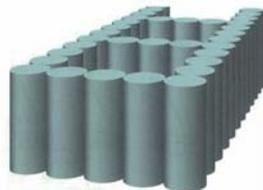
● 基礎地盤を格子状に固化改良することにより、盛土の安定を確保する。
