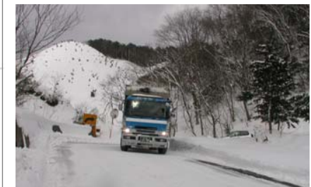
【写真①】 対向車線にはみ出して走行する大型車(曲線半径 R = 12\text{m} )
