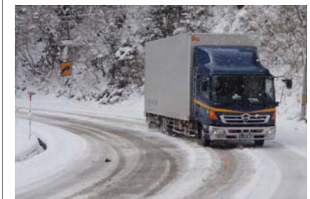
【写真③】 ヘアピンカーブを走行する大型車 (曲線半径 R = 29\text{m} )
